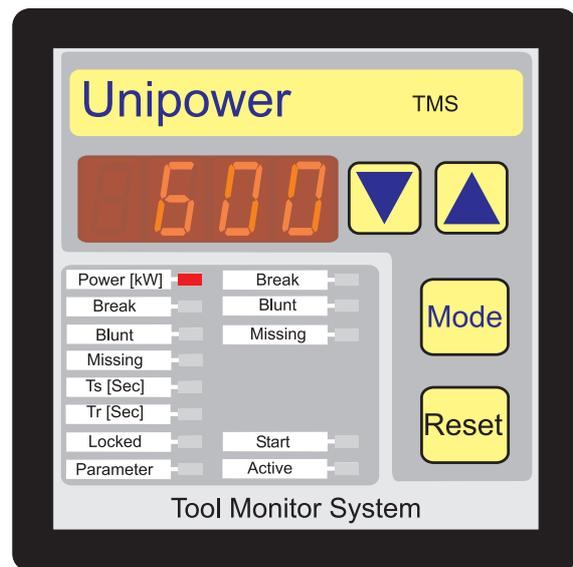
Bohrers ist dann weit geringer und liegt nur knapp über der Leerlaufleistung. In Abb. 1 ist eine solche Situation dargestellt. Die Leerlaufleistung liegt bei etwa 50%, der Leistungszuwachs durch die Bearbeitung beträgt nur etwa 10%. Über den Zoom wird nun der Bereich zwischen  $P_{1\min} = 40\%$  bis  $P_{1\max} = 70\%$  wieder zu 100% aufgelöst. Auf diese Weise ist das kleine Werkzeug auch bei großen Antriebsleistungen überwachbar.
